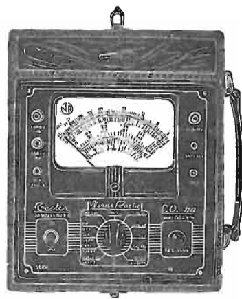
S. O. 114 TESTER 20.000 \Omega/V
